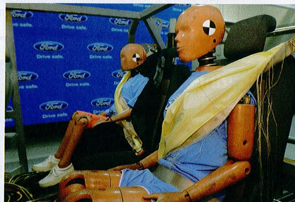
Un airbag au gaz comprimé froid.
